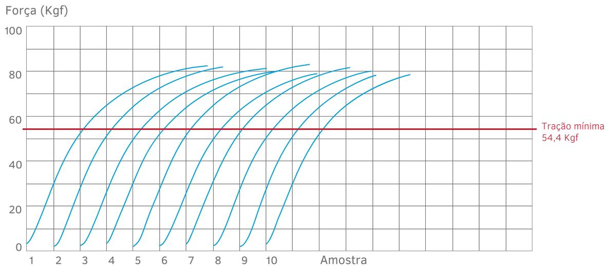
O gráfico acima representa o teste de resistência à tração realizado em 10 amostras da abraçadeira F7040. A tensão mínima de ruptura esperada é de 54,4 Kgf e o resultado apresentou valores próximos de 80 Kgf (o resultado foi 47% superior que o especificado no catálogo).
